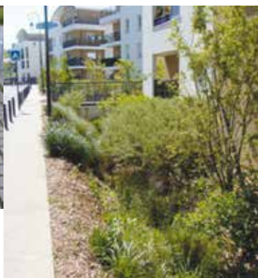
Exemple de noues créées le long de la voirie, sur le site IRSTEA à Antony. ▼
