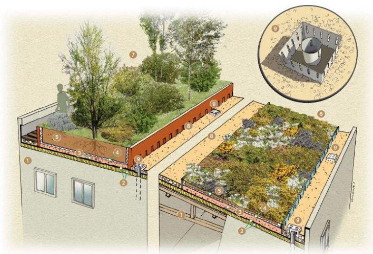
Exemple de techniques de gestion des eaux pluviales à la parcelle sans aucune connexion au réseau
