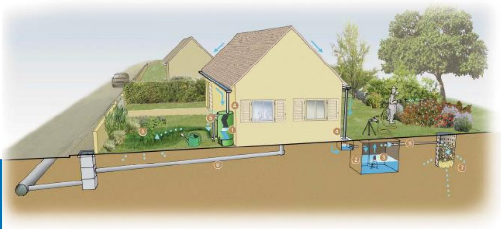
Exemple de techniques de gestion des eaux pluviales à la parcelle sans aucune connexion au réseau
